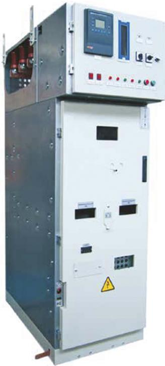
КСО-298 EICub с выкатным элементом в средней части шкафа, одностороннего обслуживания предназначены для приема и распределения электроэнергии трехфазного переменного тока 6-10 кВ систем с изолированной нейтралью, в распределительных подстанциях типа РП, ТП, БРТП. Камеры КСО-298 EICub входящие в состав распределительного устройства, соответствуют требованиям безопасности согласно ГОСТ 14693-90 ; ГОСТ 1516.3-96 .
