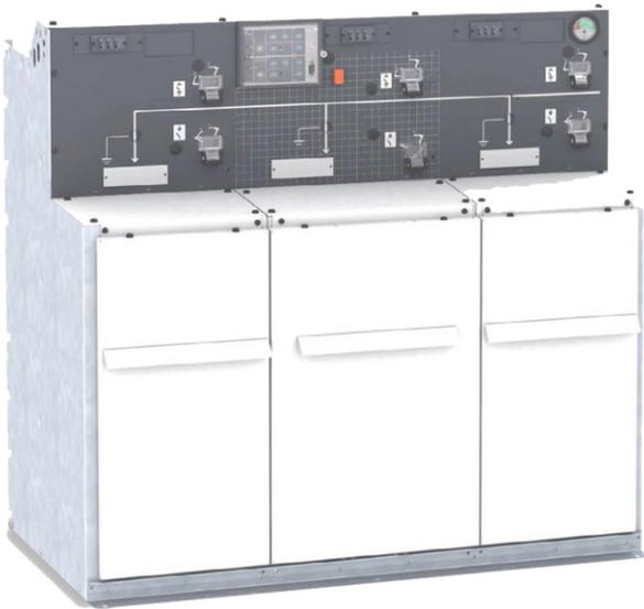
Компактное устройство, предназначенное для установки в радиальных, магистральных и петлевых распределительных сетях 6, 10, 20 кВ, выполняющее функции присоединения, питания и защиты одного или двух распределительных трансформаторов мощностью до 3 000 кВА с помощью комбинации выключателя нагрузки и плавких предохранителей или силового выключателя с защитой.
