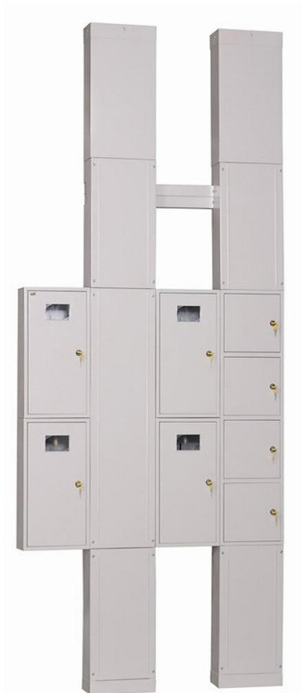
Устройства этажные распределительные модульного типа предназначены для приема, распределения и учета электроэнергии, защиты аппаратов устройств, отходящих линий от перегрузок и токов короткого замыкания в сетях с глухо-заземлённой нейтралью трехфазного и однофазного переменного тока напряжением 380/220В, частотой 50 Гц, а также для размещения устройств телефонных, радиотрансляционных, телевизионных сетей, интернет сетей и оборудования автоматической системы контроля учёта электроэнергии (АСКУЭ).
