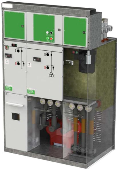
Шкафы КРУЭ EICub 6(10), 20 и 35 кВ предназначены для работы в составе распределительных устройств в сетях трехфазного переменного тока частотой 50 Гц, номинальным напряжением 6, 10, 20 и 35 кВ с изолированной, заземленной через дугогасительный реактор или резистор нейтралью.
